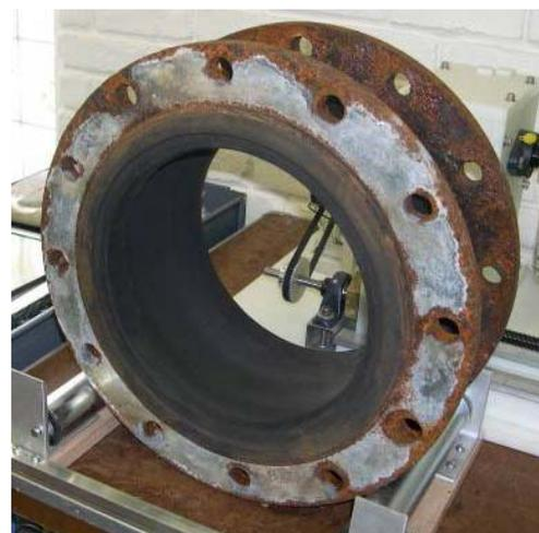
**FIGURE 2: EXPANSION JOINT MOCK-UP**
